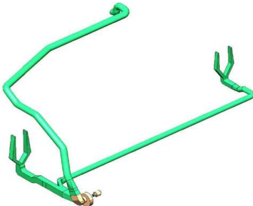
Рис 16. Рециркуляция во вторичный воздух. Тракт «Е2».
