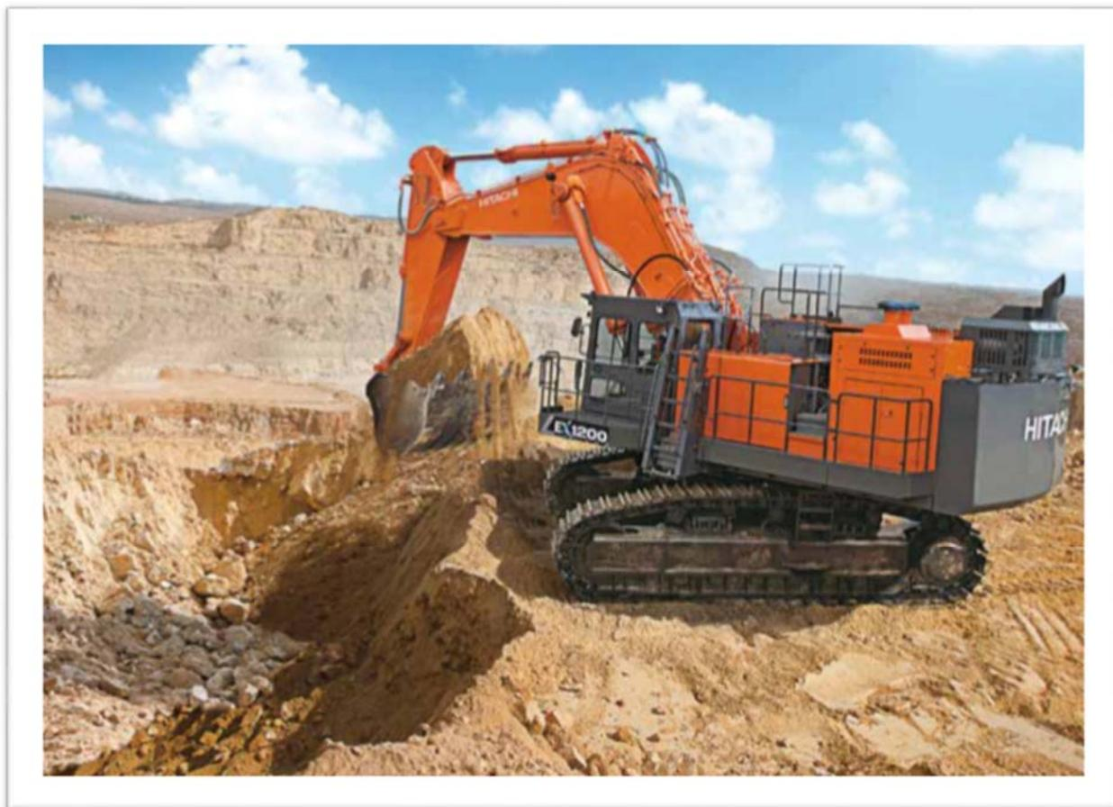
Рисунок 5.10 - Гидравлический экскаватор Hitachi EX1200-6 с ковшом 5,9 м<sup>3</sup>.
