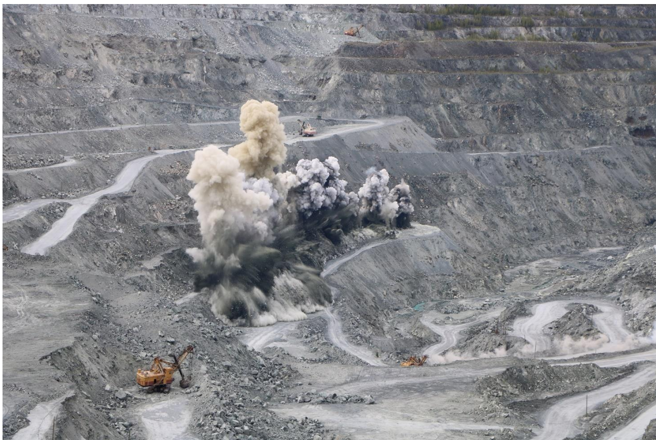
Рис. 7. Буровзрывные работы в карьере
