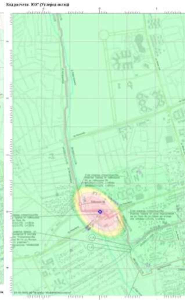
Рисунок 5.5. Карта рассеивания углерода оксида
