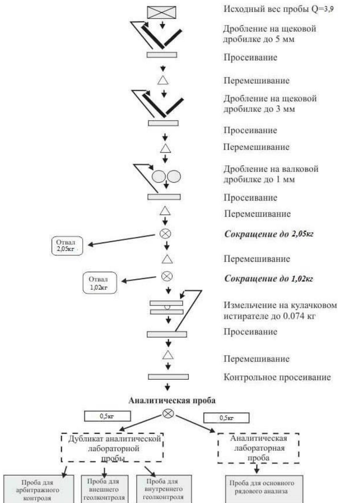
Рис. 4.2 Схема обработки бороздовых ан.
