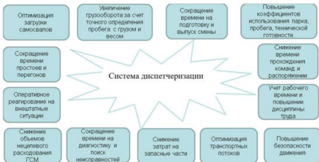
Рисунок 8.1. - Структура и функции системы диспетчеризации
