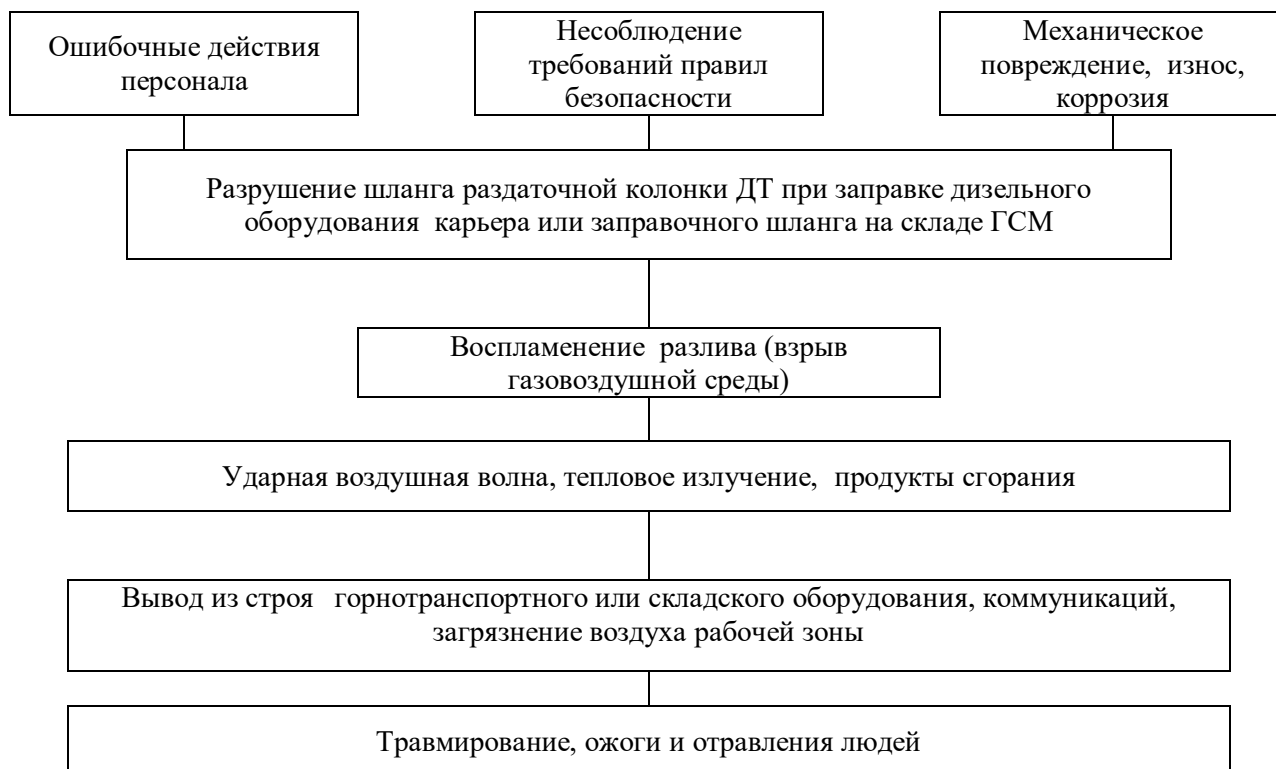
Рисунок 10.2 - Блок-схема вероятного сценария возникновения и развития аварии при заправке дизельного технологического оборудования карьера из топливозаправщика или заправке емкости на складе ГСМ
