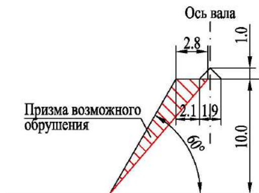
Призма возможного обрушения
