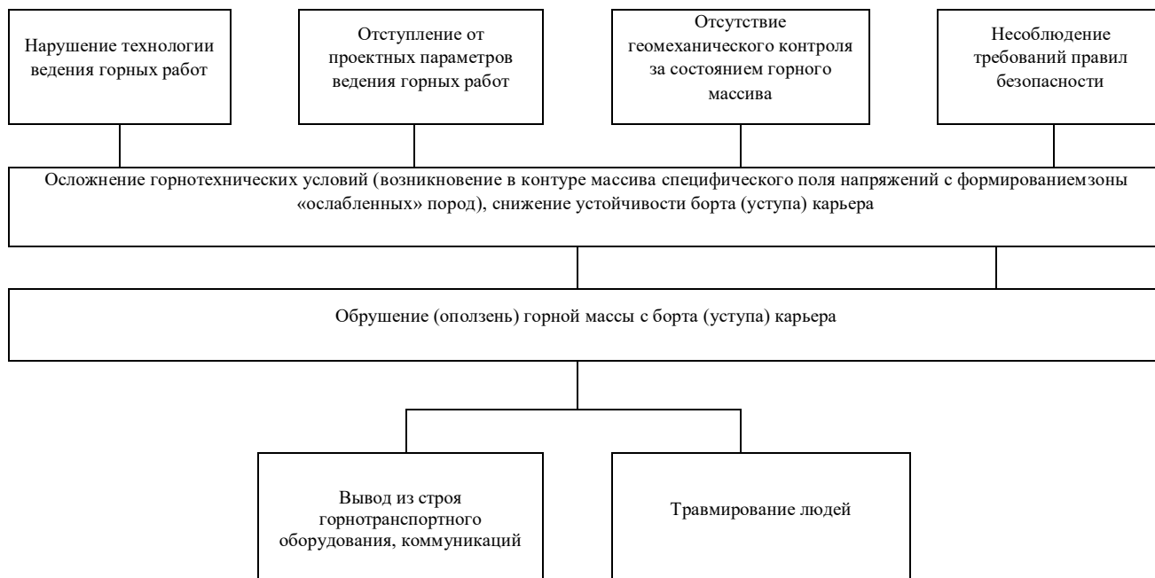
Рисунок 10.1 - Блок-схема вероятного сценария аварии при обрушении (оползней) горной массы с борта (уступа) карьера
