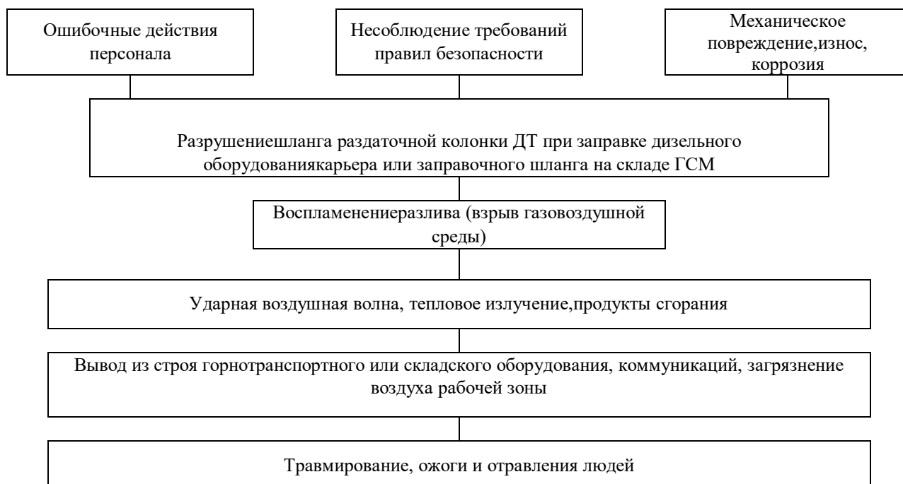
Рисунок 10.2 - Блок-схема вероятного сценария возникновения и развития аварии при заправке дизельного технологического оборудования карьера из топливозаправщика или заправке емкости на складе ГСМ
