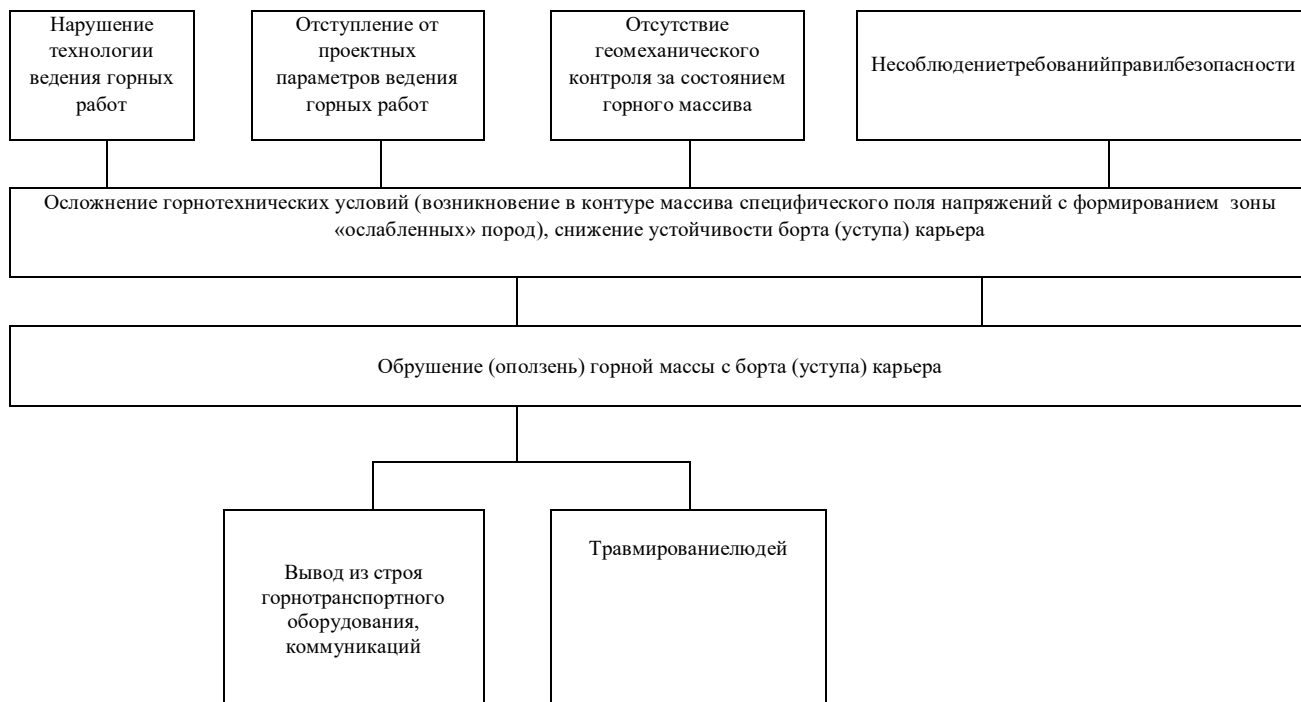
Рисунок 10.1 - Блок-схема вероятного сценария аварии при обрушении (оползней) горной массы с борта (уступа) карьера
