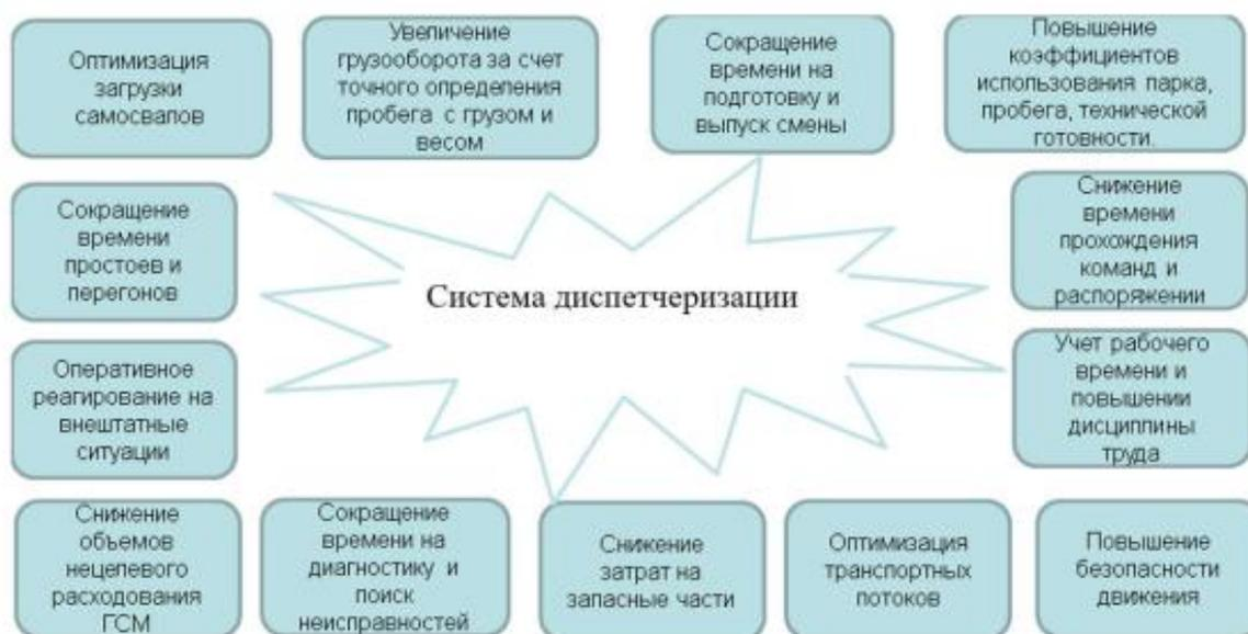
Рисунок 8.1. Структура и функции системы диспетчеризации
