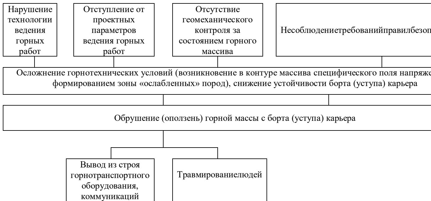
Рисунок 10.1 - Блок-схема вероятного сценария аварии при обрушении (оползней) горной массы с борта (уступа) карьера
