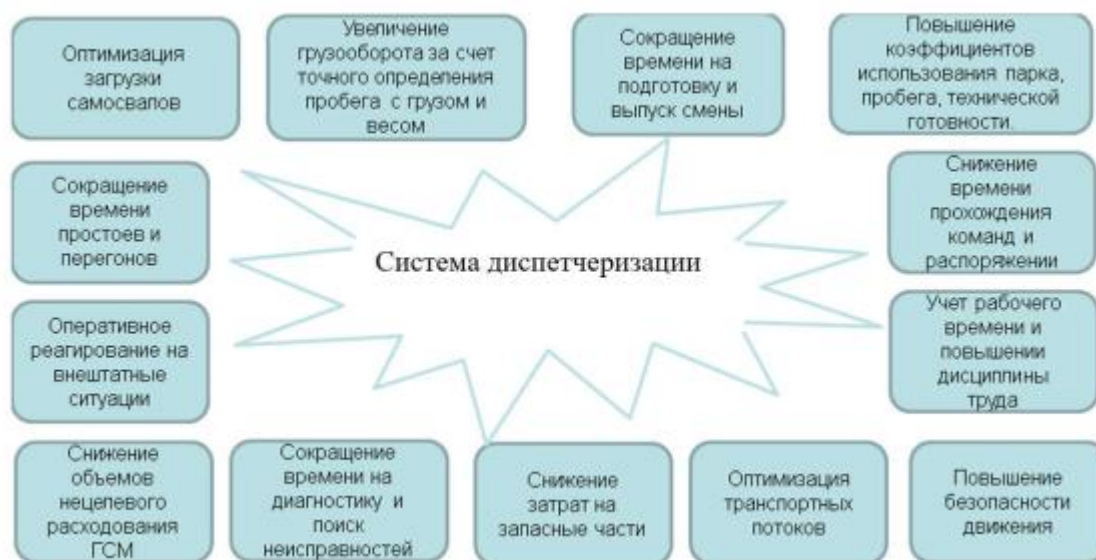
Рисунок 8.1. - Структура и функции системы диспетчеризации
