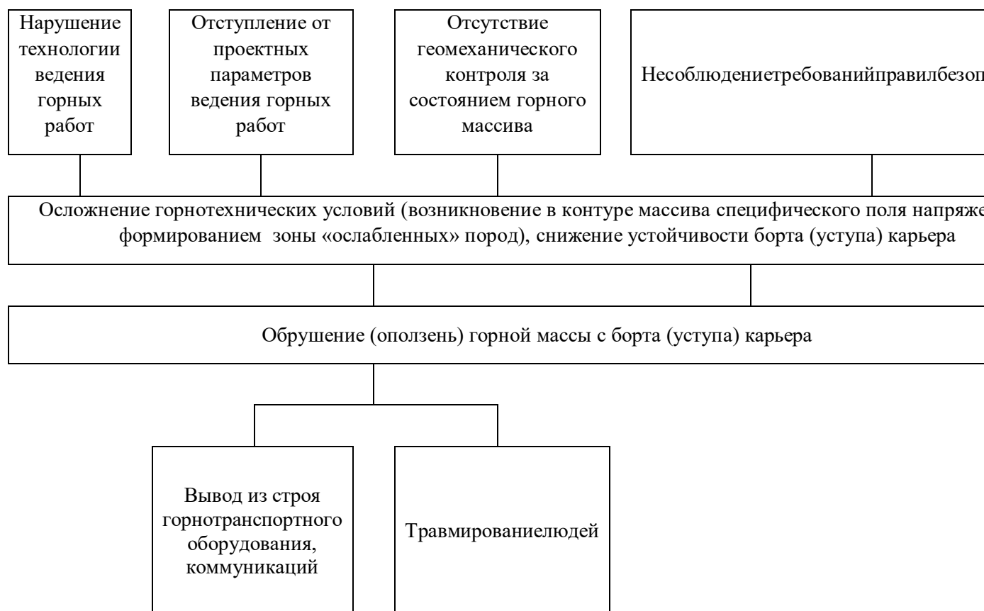
Рисунок 10.1 - Блок-схема вероятного сценария аварии при обрушении (оползней) горной массы с борта (уступа) карьера
