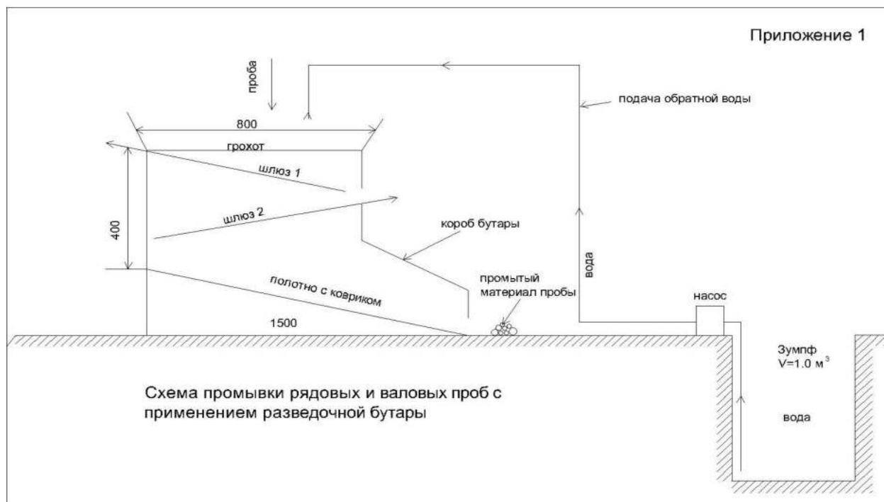
Рис. 2.3.1 Схема промывки рядовых и валовых проб с применением разведочной бутары
