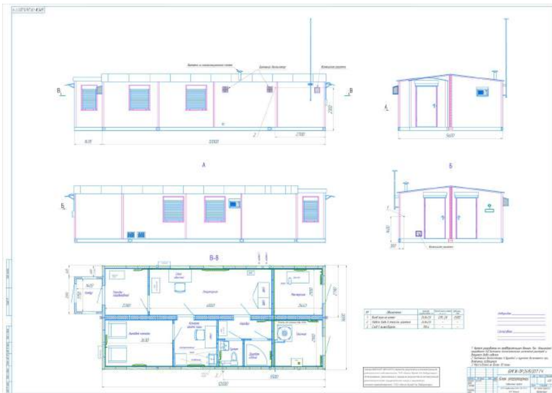
Блок операторной АГРС «ПГУ-75»
