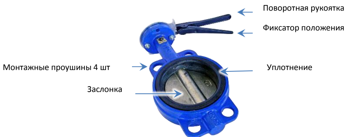
Устройство затвора
