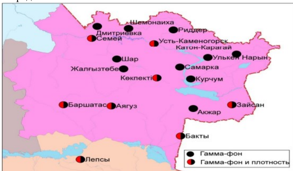
Рис. 5.8 Схема расположения метеостанций за наблюдением уровня радиационного гамма - фона и плотностью радиоактивных выпадений на территории Восточно - Казахской области
