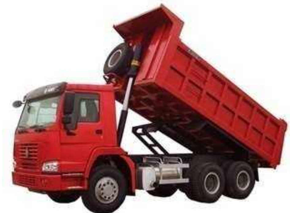
Рис.6. HOWO Самосвал 6x4 (340 л.с.), грузоподъемностью 25 тонн, кузов 5400x2300x1500 мм.
