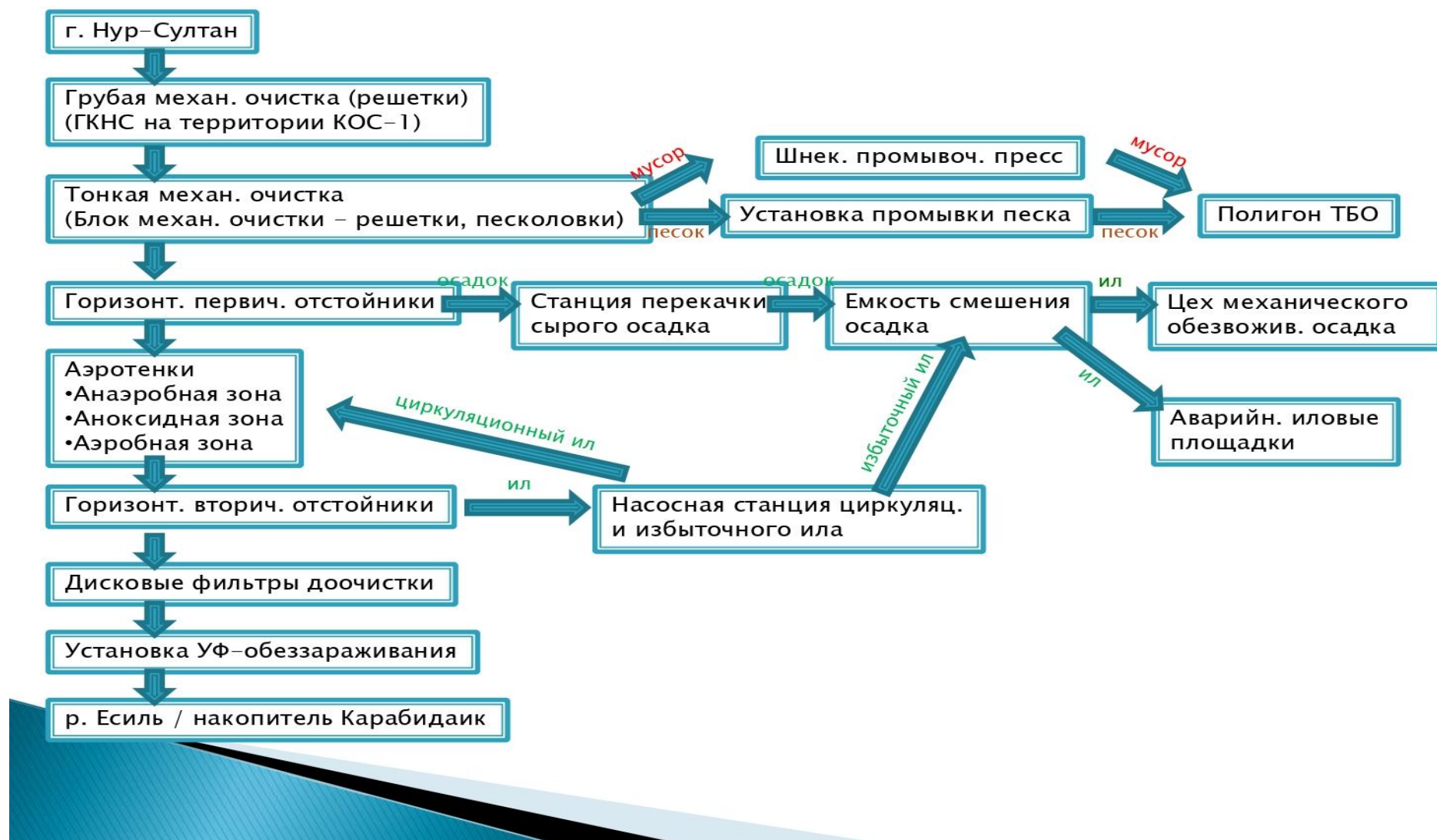
Рис 6. Схема технологического процесса очистки сточных вод на КОС № 2 г. Астаны на проектное положение
