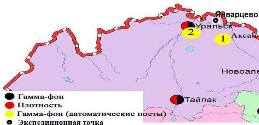
Рис. 1-4 Схема расположения метеостанций за наблюдением уровня радиационного гамма-фона и плотности радиоактивных выпадений на территории Западно-Казахстанской области
