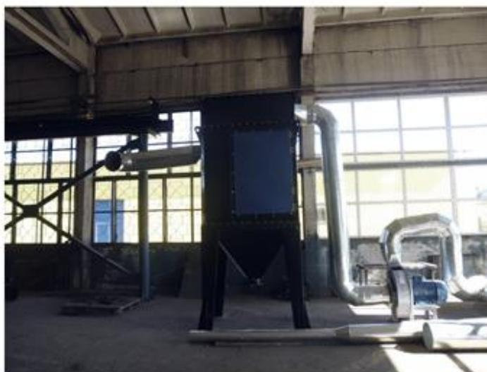
Рукавные фильтры «Буран пневмо» от компании «Факел» являются классическими рукавными фильтрами для очистки воздуха и газов от загрязнения. Фильтры «Буран» зарекомендовали себя как надежные и не прихотливые установки.
