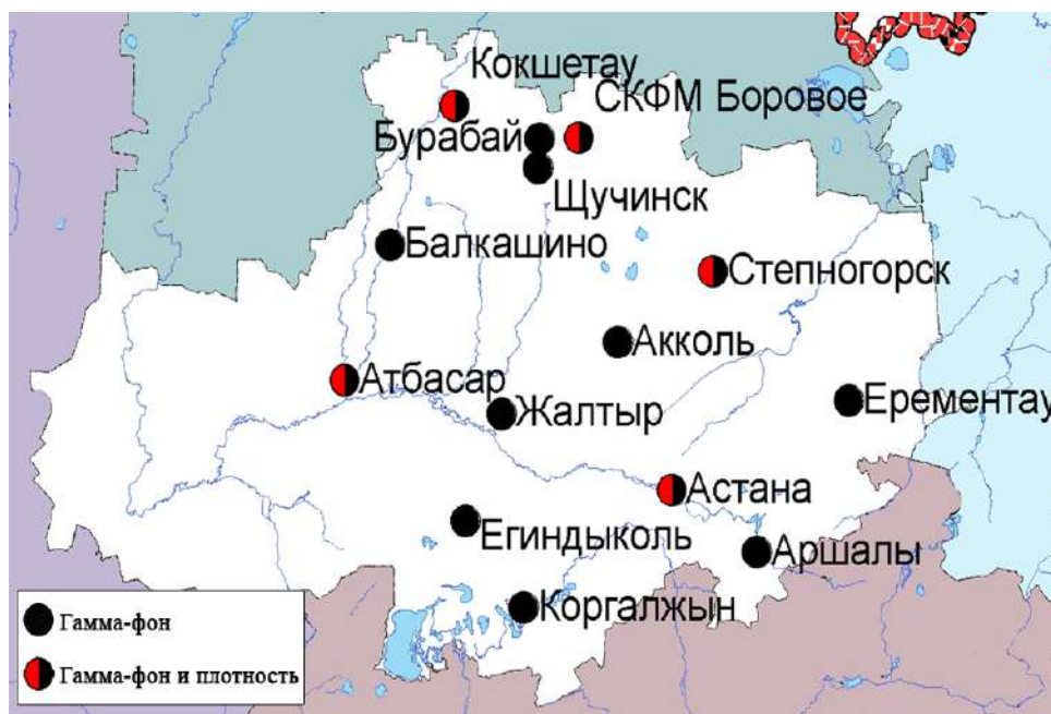
Рис. 3 Схема расположения метеостанций за наблюдением уровня радиационного гамма-фона и плотностью радиоактивных выпадений на территории Акмолинской области
