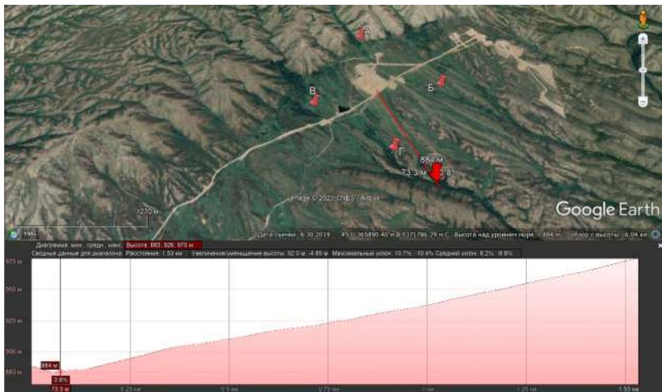
Рис. 12. Направление растекания воды при прорыве дамбы. I этап.
