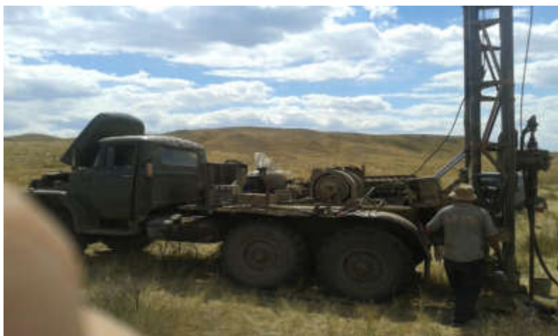
Буровая установка ЛБУ-50 для бурения гидрогеологических скважин
