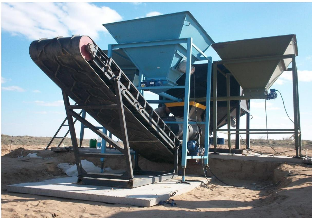
Установка предназначена для смешивания бурового шлама, замазученного грунта с цементом, песком, опилками, известью и другими вяжущими веществами. Вяжущие создают при смешивании с буровым
