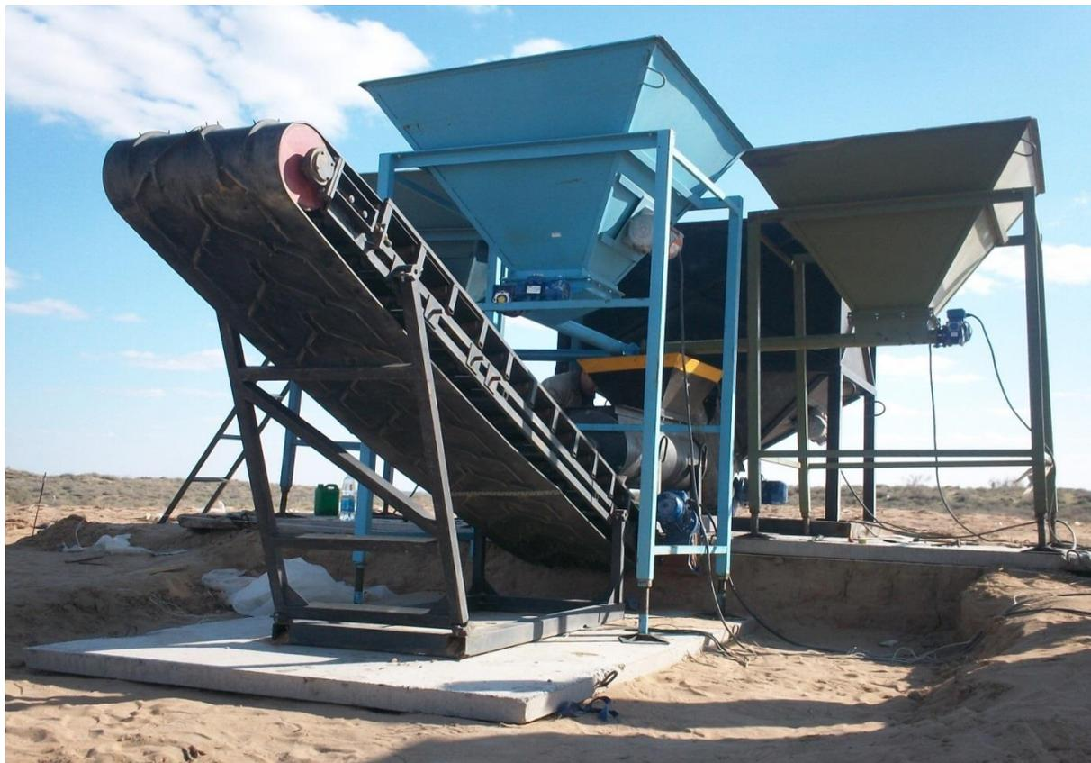
Возможность смешивания до 4-х компонентов в пропорции  $100\% \times 10\% \times 10\% \times 10\%$ , размер перерабатываемой фракции – до 5 мм, быстро собираемая - разбираемая конструкция, состоящая из отдельных модулей, производительность установки -  $10 \text{ м}^3/\text{час}$ .
