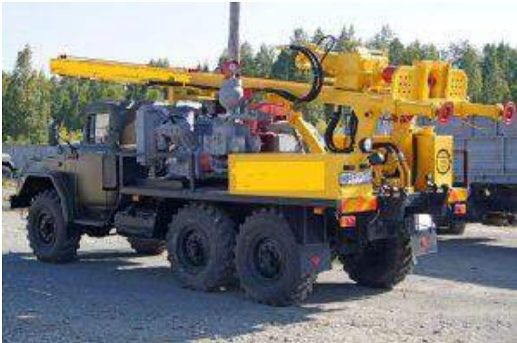
Рис. 5.2. Малогабаритная буровая установка УРБ-2А2
