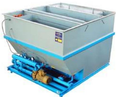
**Блочные установки очистки ливневых стоков "КЛЮЧ.Н"** предназначены для очистки ливневых сточных вод с территорий промышленных площадок, автомобильных заправочных станций, автохозяйств, нефтебаз, предприятий ж/д транспорта, а также ряда производственных сточных вод. Используются совместно с аккумулялирующими емкостями, выполняющими роль первичного отстойника.
