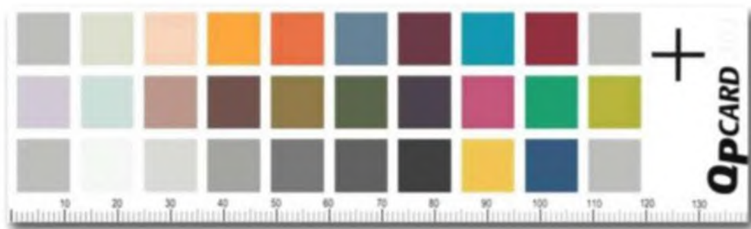
Рис. 6.4.1. Пример цветной/черно-белой контрольной полосы, которая может быть использована для корректировки цветового баланса
