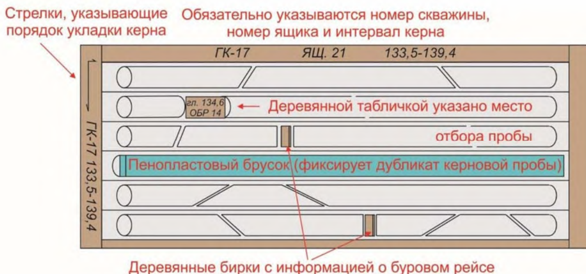
Рис. 6.5.1. Схематическое изображение керна (кернового ящика), из которого отобраны различные виды проб
