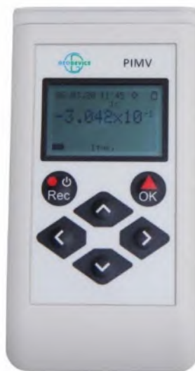
Рис. 6.4.3. Каппаметр ПИМВ — портативный измеритель магнитной восприимчивости
