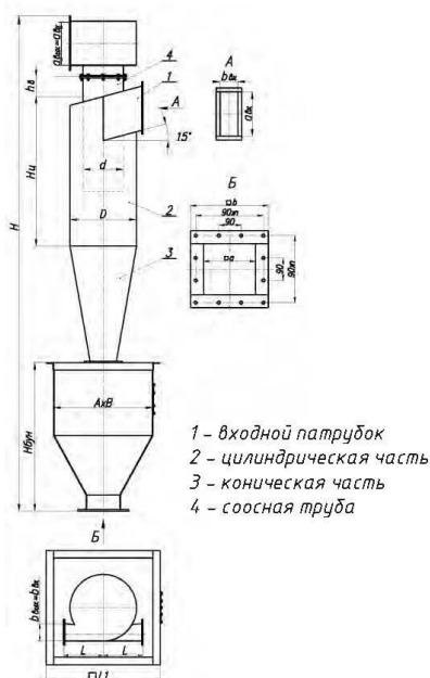
Рис. 10. Общий вид. Габаритные размеры циклонов ЦН-15х1УП.
