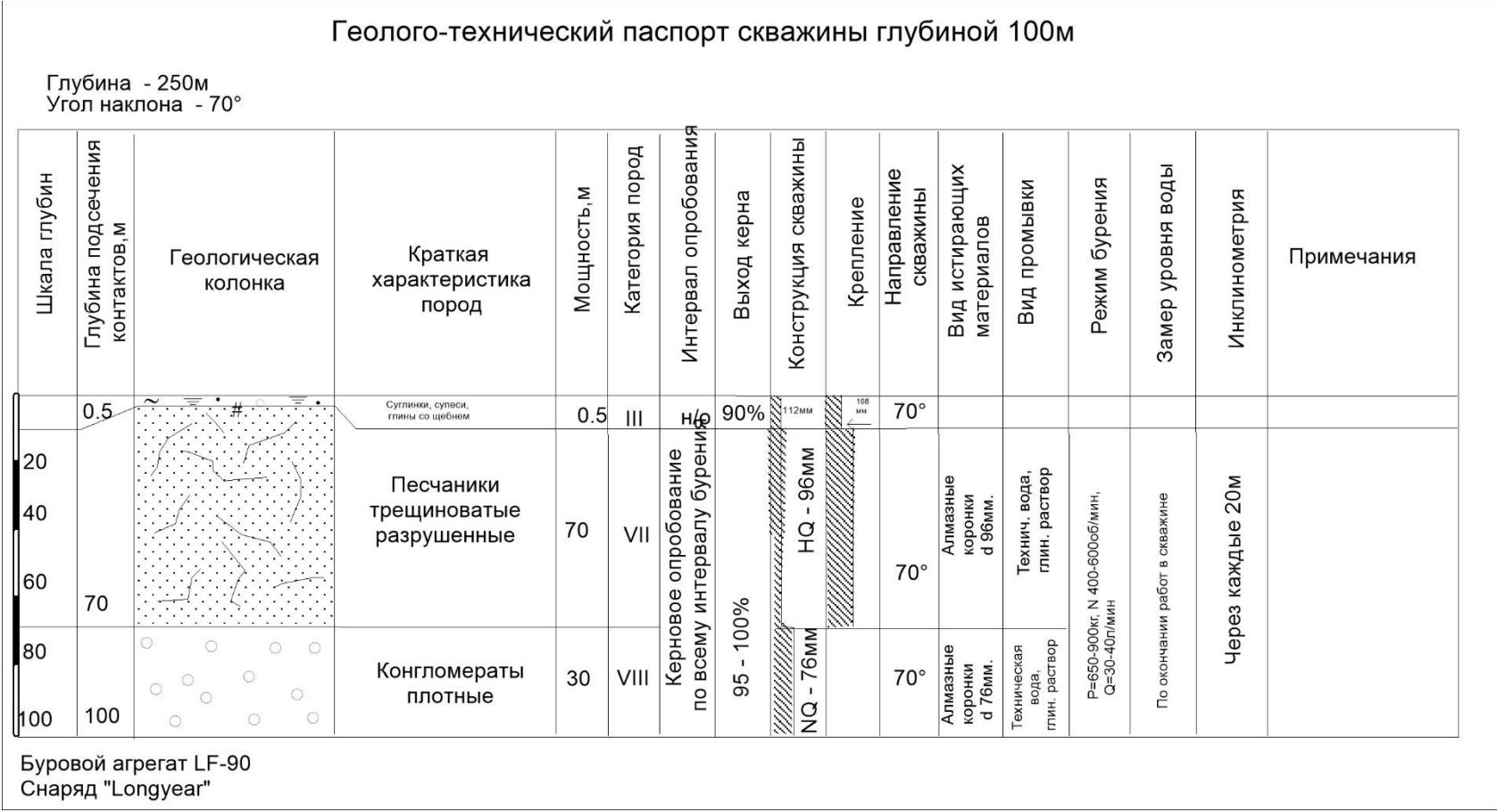
Рисунок 5.3 Геолого-технический паспорт скважины глубиной 100м.
