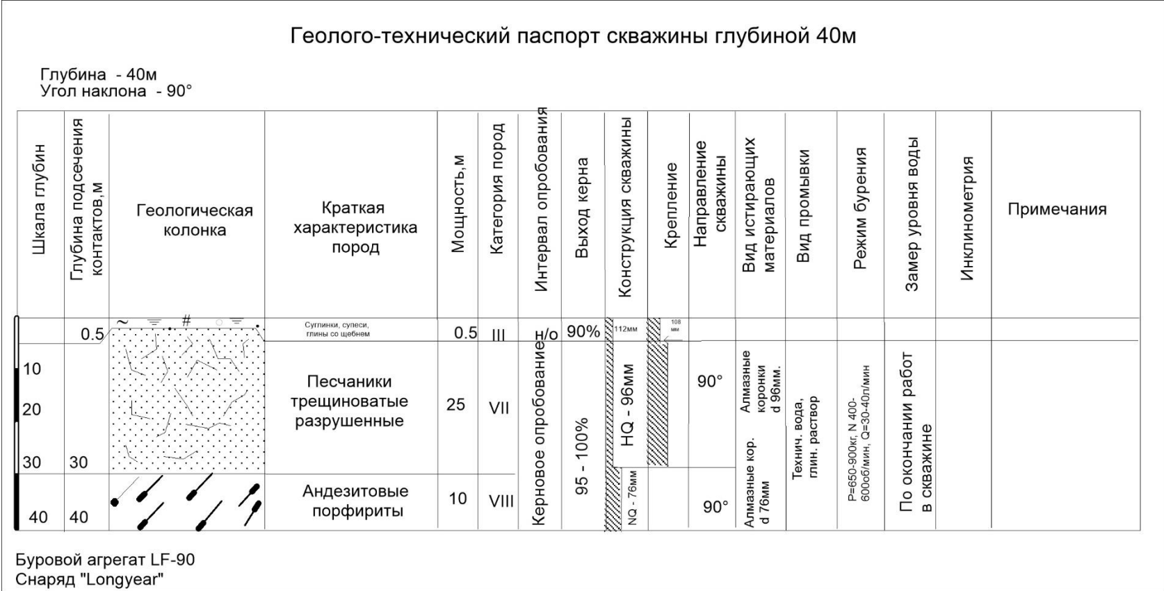
Рисунок 5.2 Геолого-технический паспорт скважины глубиной 40м.
