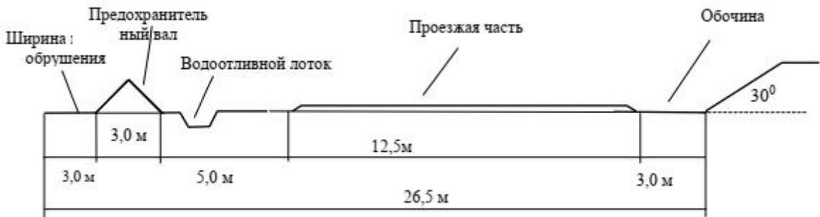
6. Ширина въездной и разрезной траншей по низу рассчитана для условий устройства двухполосной дороги.
