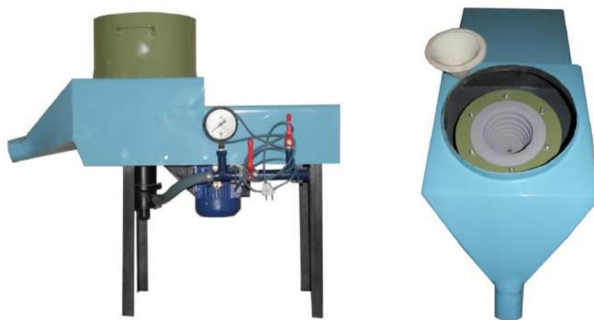
Рис. 5.1 Сепаратор-концентратор URALGOLD CK-007-800
