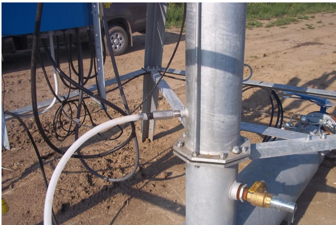
Рисунок 12 - Узел соединения дождевальной машины и переносного дозатора
