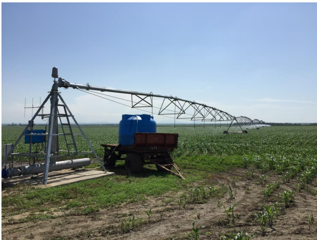
Рисунок 10 – Размещение передвижного растворного узла для внесения удобрений
