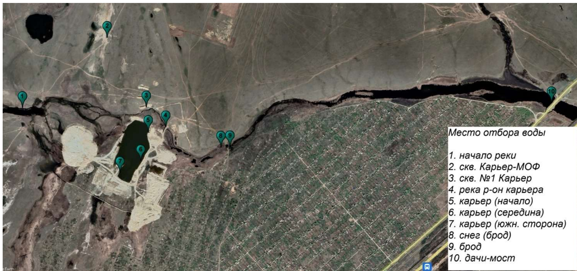
Рис. 1.2.2.2. Схема расположения точек контроля поверхностных и подземных вод
