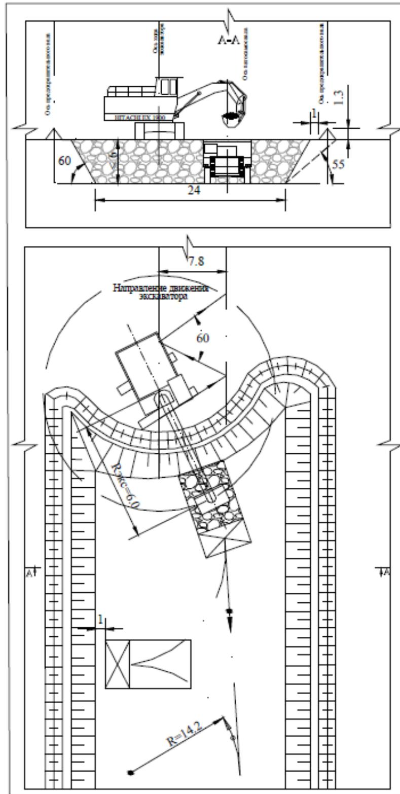
Рисунок 3.1-Схема проходки траншеи (съезда) гидравлическим экскаватором с нижним черпанием и погрузкой в автосамосвалы на уровне подошвы траншеи. Ширину основания съезда принимаем равную 24 м.
