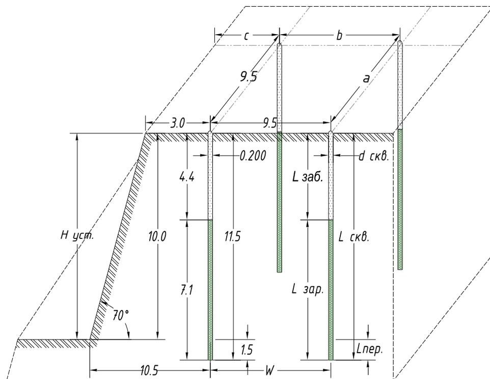
Рисунок 3.5-Параметры конструкции скважинного заряда на рудных уступах
