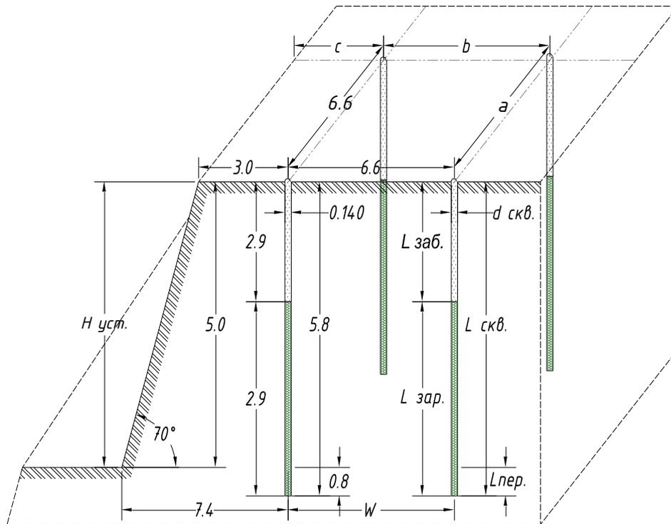
Рисунок 3.6-Схема монтажа взрывной сети при производстве буровзрывных
