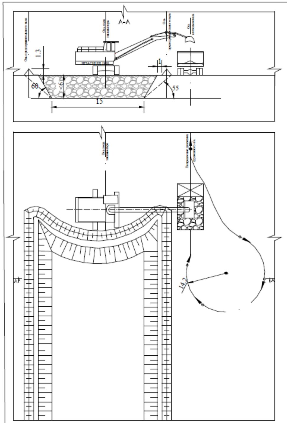
Рисунок 3.2-Схема проходки траншеи (съезда) гидравлическим экскаватором (обратная лопата) с нижним черпанием и погрузкой в автосамосвалы на уровне стояния экскаватора, с петлевым разворотом
