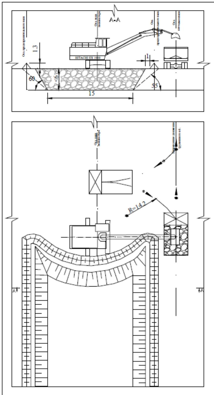
Рисунок 3.3-Схема проходки траншеи (съезда) гидравлическим экскаватором (обратная лопата) с нижним черпанием и погрузкой в автосамосвалы на уровне стояния экскаватора, с тупиковым разворотом
