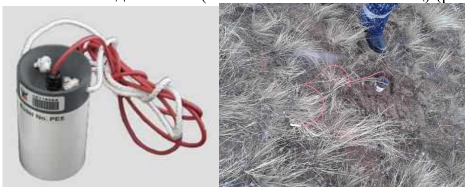
Рис. 5.9 - Неполяризующийся малощумящий электрод PE5
