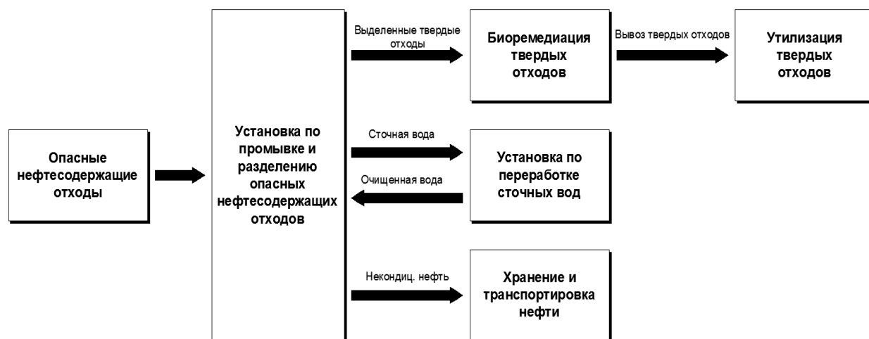
Рис. 1.5.1.1 – Процесс переработки опасных нефтесодержащих отходов с использованием технологии промывки и биоремедиации
