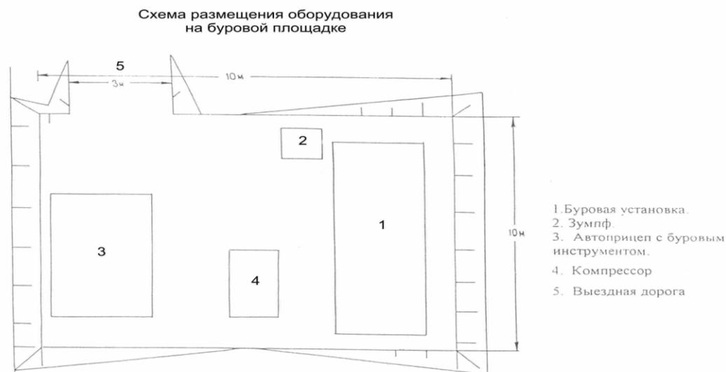
Рисунок 5. Схема размещения оборудования на буровой площадке
