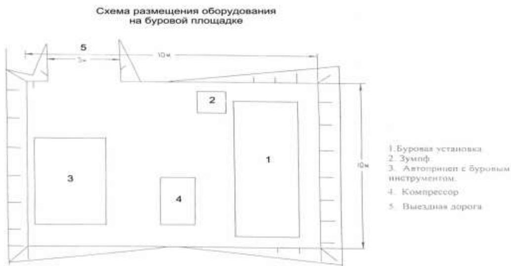
**Рисунок 5.1** Схема размещения оборудования на буровой площадке
