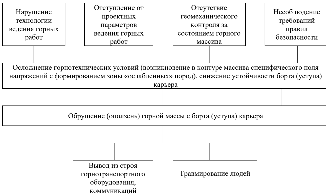
Рис.1.14.1 - Блок-схема вероятного сценария аварии при обрушении (оползней) горной массы с борта (уступа) карьера
