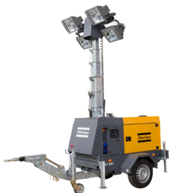
Рис. 1.11.1 - Осветительная мачта типа Atlas Copco QLT H50
