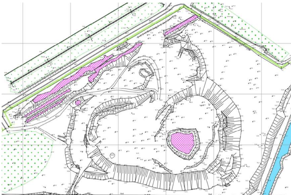
Рисунок 3. – Участки водоотведения с отвала №1
