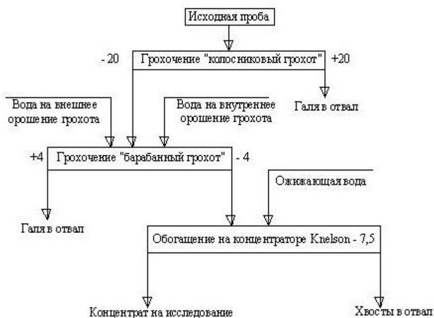
Рис. 3 Принципиальная технологическая схема установки “Prospecting Egiurment” фирмы FMW (Австрия) для технологического опробования
