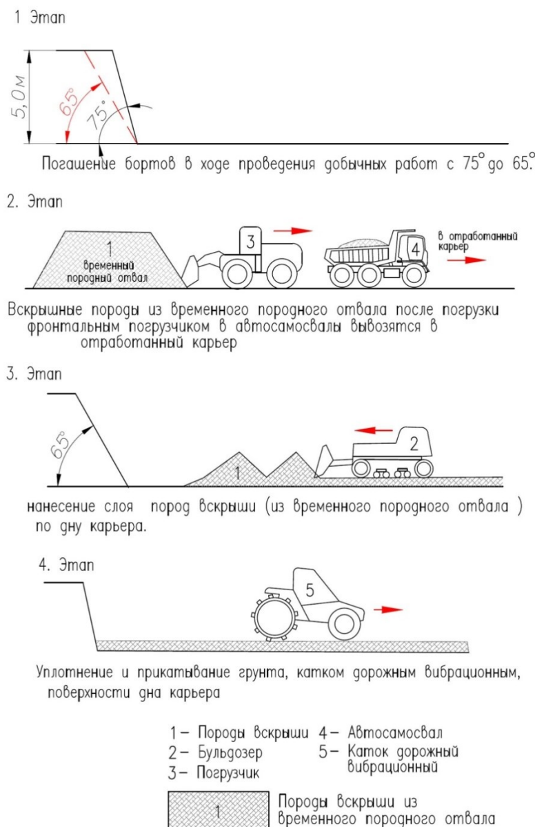
Рис.7.3.3 Принципиальная схема рекультивации карьера строительного камня
