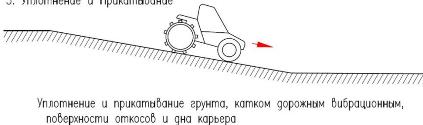
Рис.7.3.2 Принципиальная схема рекультивации грунтовых карьеров
