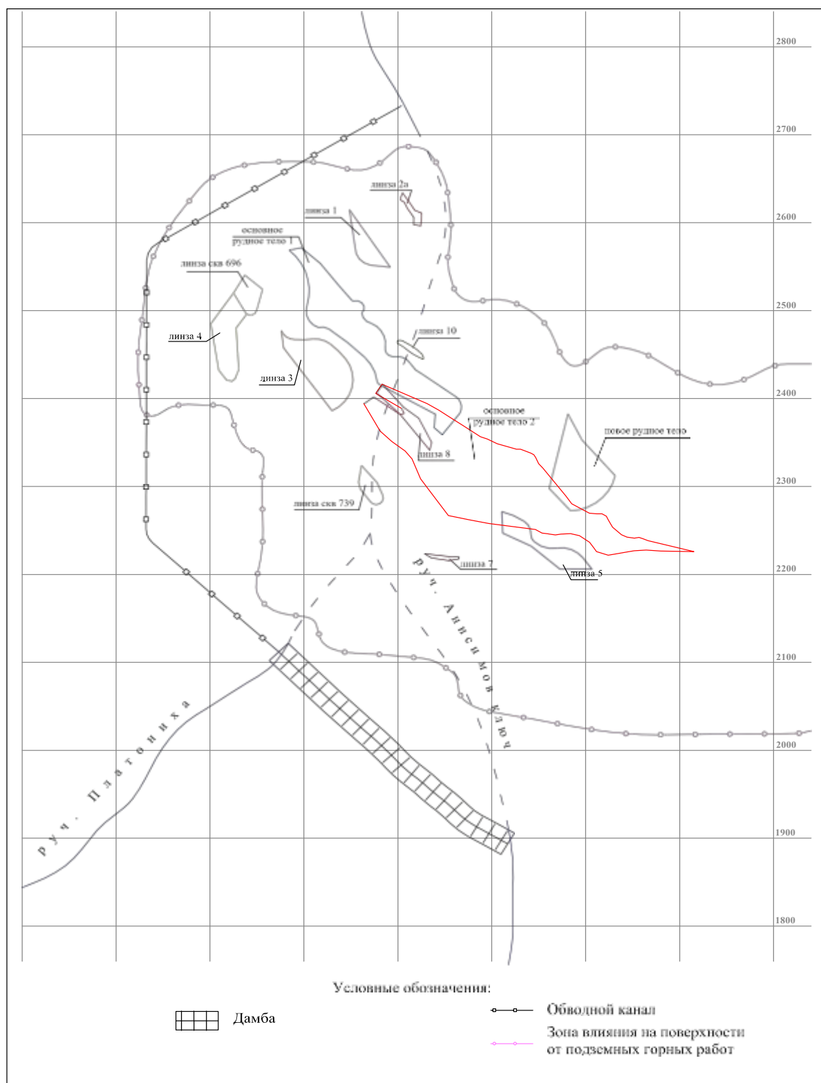
Рисунок 5. Схема отвода ручьев за пределы зоны сдвижения горных пород. Вариант 1.
