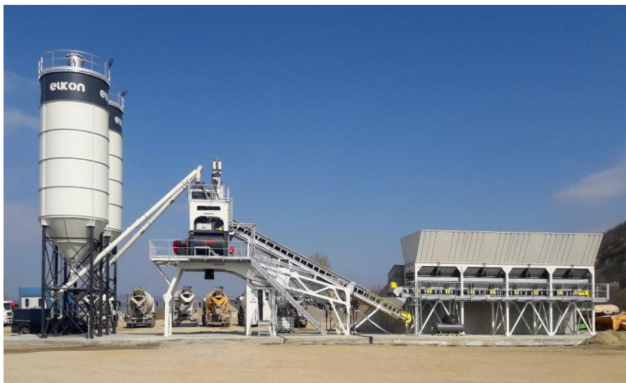
Рисунок 2. Общий вид установки по производству бетона без кровельного покрытия
