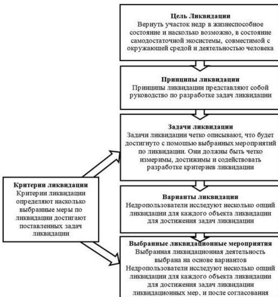
Рисунок 2. - Схематическое изображение метода планирования ликвидации
