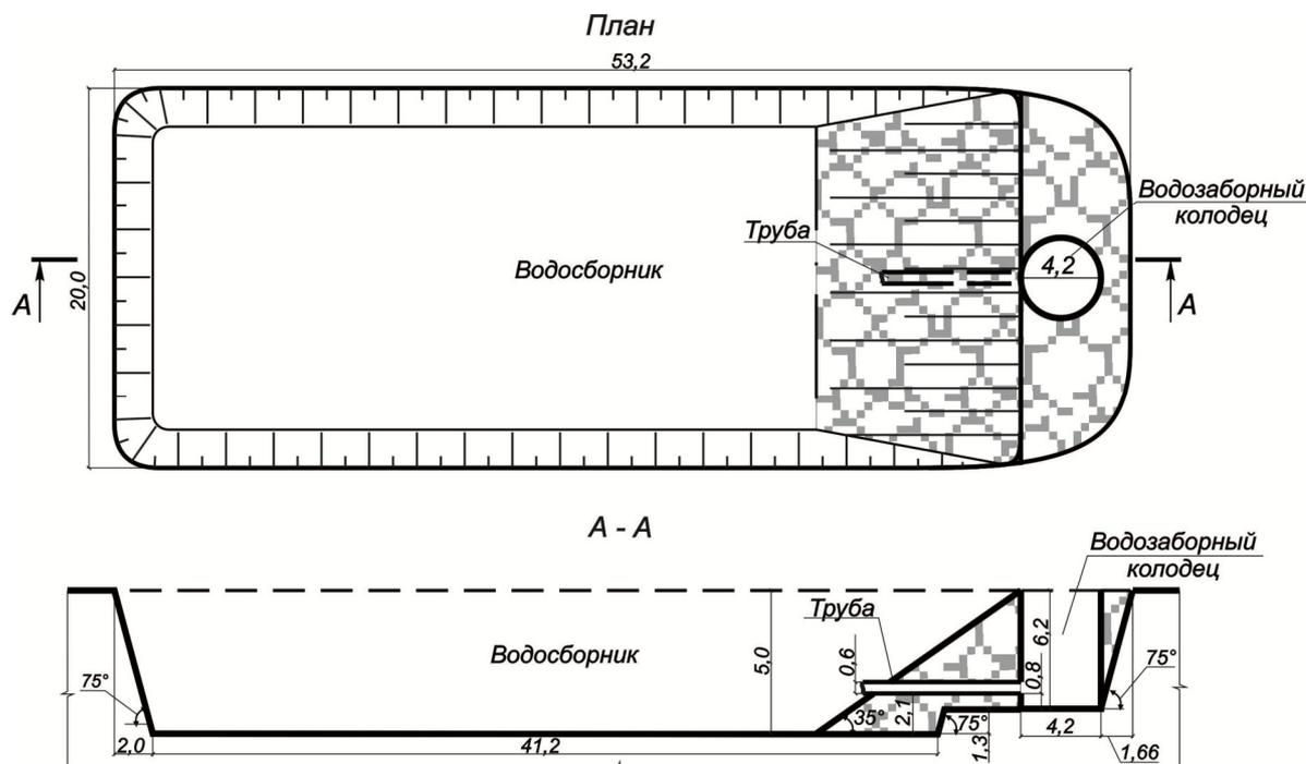
Рис. 5.2 Конструкция водосборника
