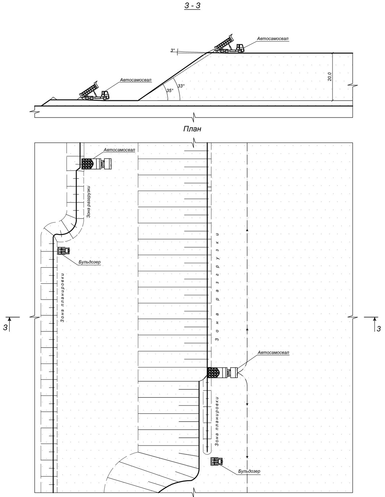
**Рис. 5.1 Технологическая схема бульдозерного отвалообразования**
