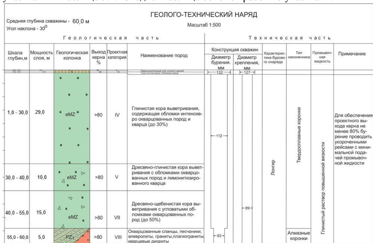
Рис. 5.4. Геолого-технический наряд на бурение колонковых скважин, глубиной 60 м.
