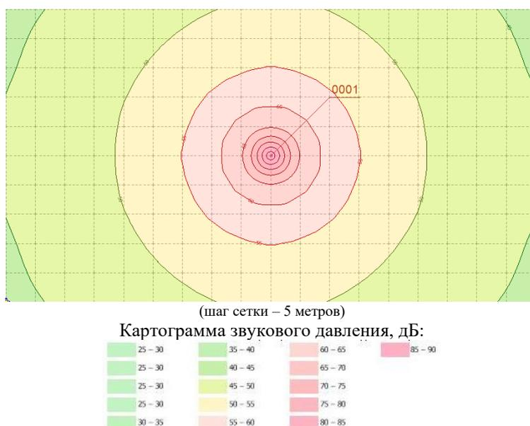
Рисунок 2 – Результаты расчёта затухания звука в графической форме в рабочей зоне оборудования при проведении разведочных работ (эквивалентный уровень звука – интегральный показатель)
