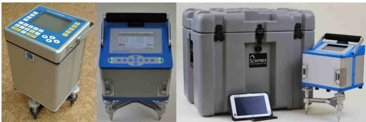
Рис. 5.4.3.3. Внешний вид гравиметров Autograv CG-5 и CG-6
