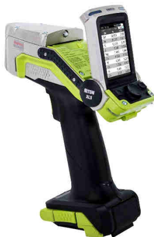
Рис. 5.5.1 Портативный XRF анализатор Niton XL5.
